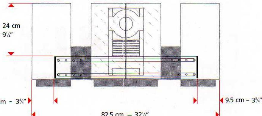
Vægskinnen er forsynet med 8 fastspændings-huller i hver side, for at gøre op hængningen så fleksibel som mulig. Normalt vil to kraftige skruer være nok (én i hver side, i den øverste række huller).
